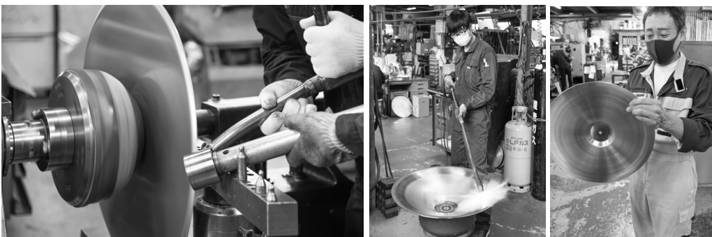
左/ 集中力を要する作業。中/ 素材をバーナーで焼き入れ。右/ ヘラ絞り加工工場の富永社長
